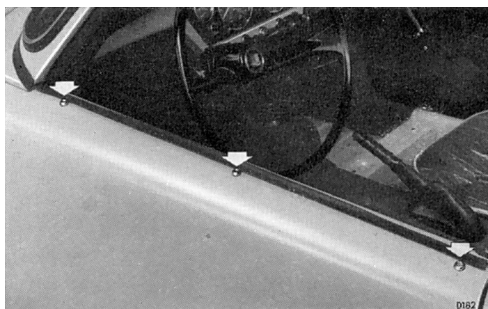
Fig. 49. Points de fixation latéraux de la toile de protection
