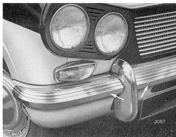
Fig. 27. Fixation de l'enjoliveur de pare-chocs (Vitesse 6)
