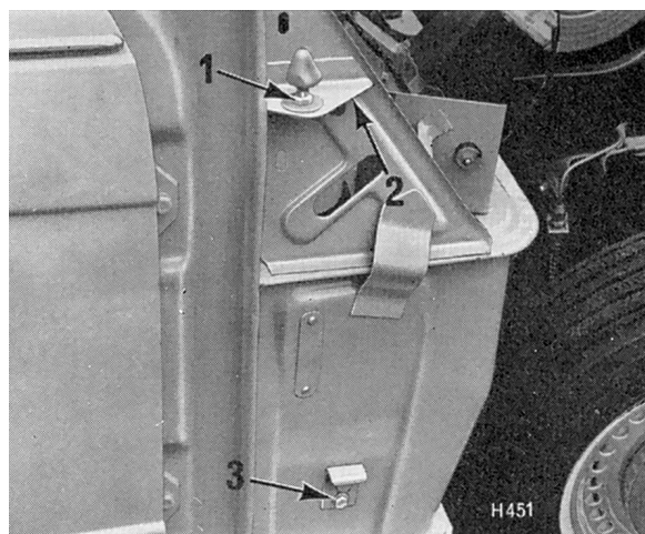
Fig. 15. Réglage du capot en hauteur (situation "C")
