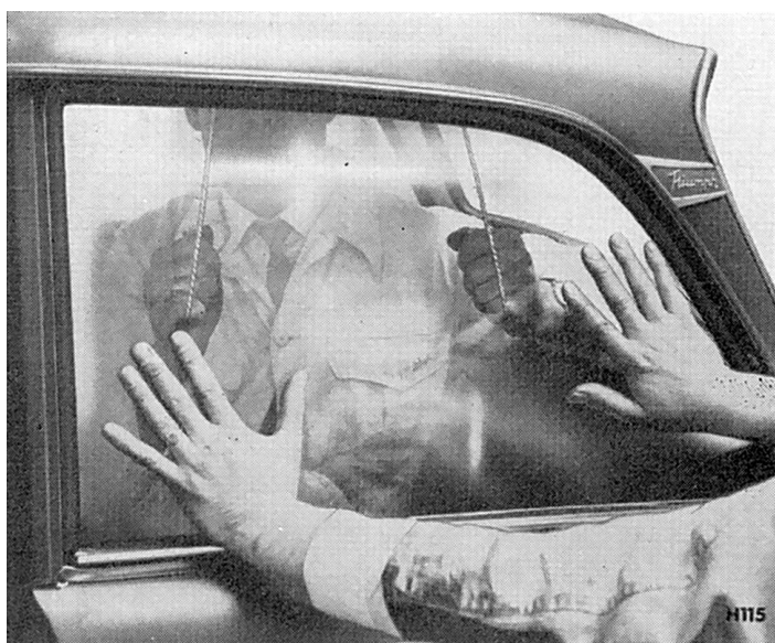
Fig. 87. Montage de la vitre latérale
