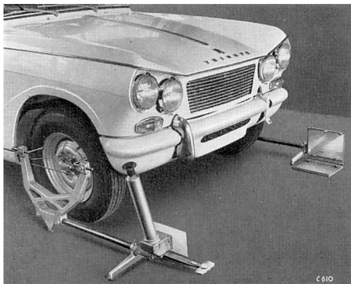
Fig. 2. Utilisation de l'indicateur optique Dunlop pour la mesure du parallélisme des roues
