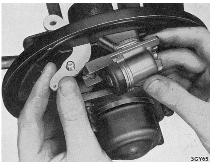
Fig. 28. Dépose du cylindre de roue arrière
