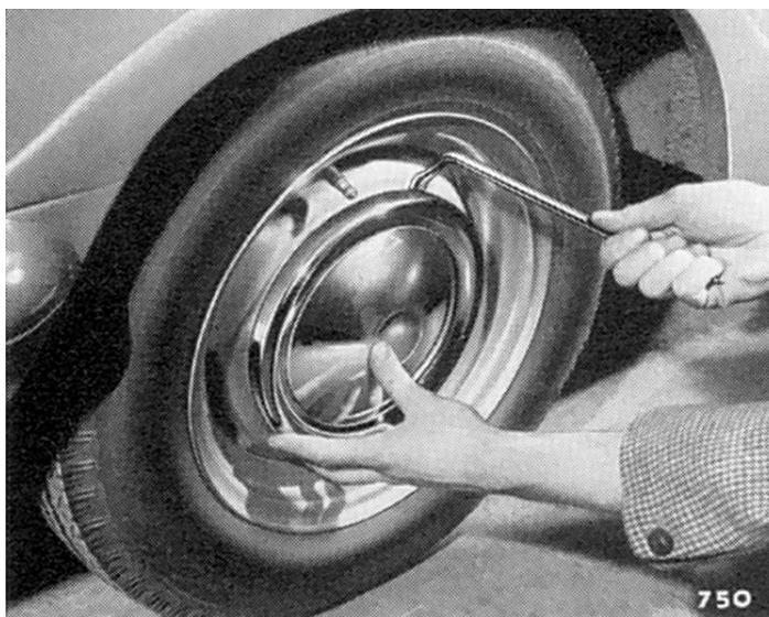
Fig. 1. Dépose de l'enjoliveur (Herald 1200, 12/50 et Spitfire)
