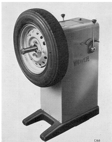
Fig. 4. Vérification de l'équilibre dynamique de l'ensemble roue et pneumatique)
