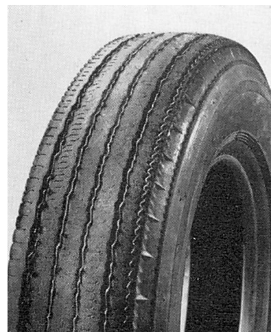
Fig. 12. Usure d'un pneumatique causée par un mauvais parallélisme des roues avant
