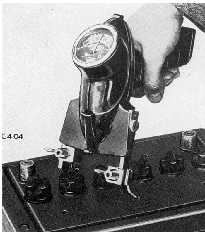
Fig. 6. Utilisation d'un appareil de test de décharge
