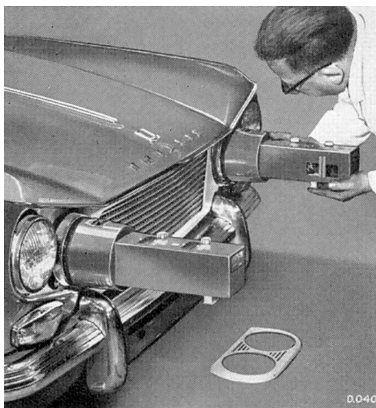
Fig. 53. Fixation des ensembles Lev-L-Lite aux phares
