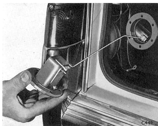
Fig. 74. Dépose de l'unité émettrice (Herald et Vitesse)
