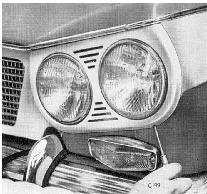
Fig. 56. Repose de l'encadrement de phare
