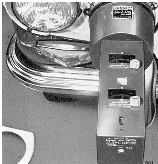
Fig. 54. Vérification du phare
