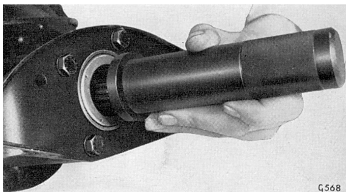
Fig. 25. Emploi d'une chasse pour poser un joint neuf
