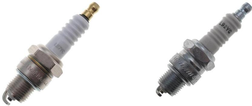
Le réglage des bougies réside au bon écartement des électrodes. Ce dernier doit être de l'ordre de 0,032 inch soit 0,8 mm.
