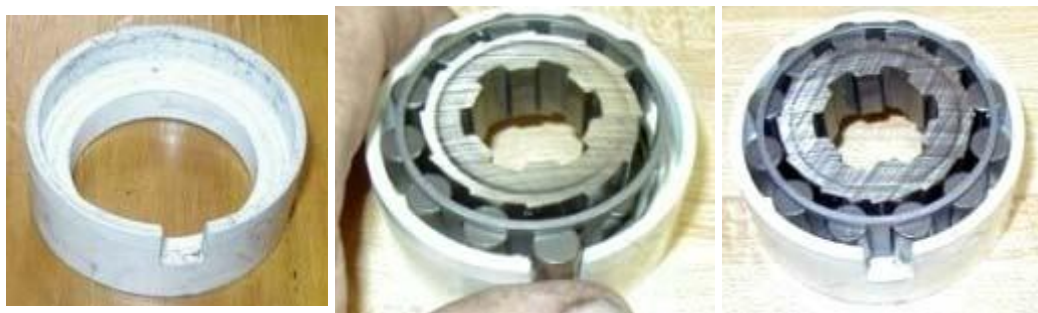
Fig. 7 Mise en place des galets avec l'outil spécial
