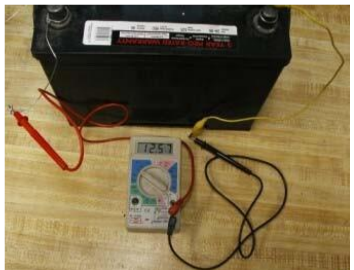
Fig. 3 Contrôle du multimètre
