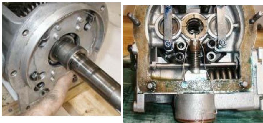
Fig. 1 Contrôle de l'orientation de la pompe et du maintien du piston en position basse
