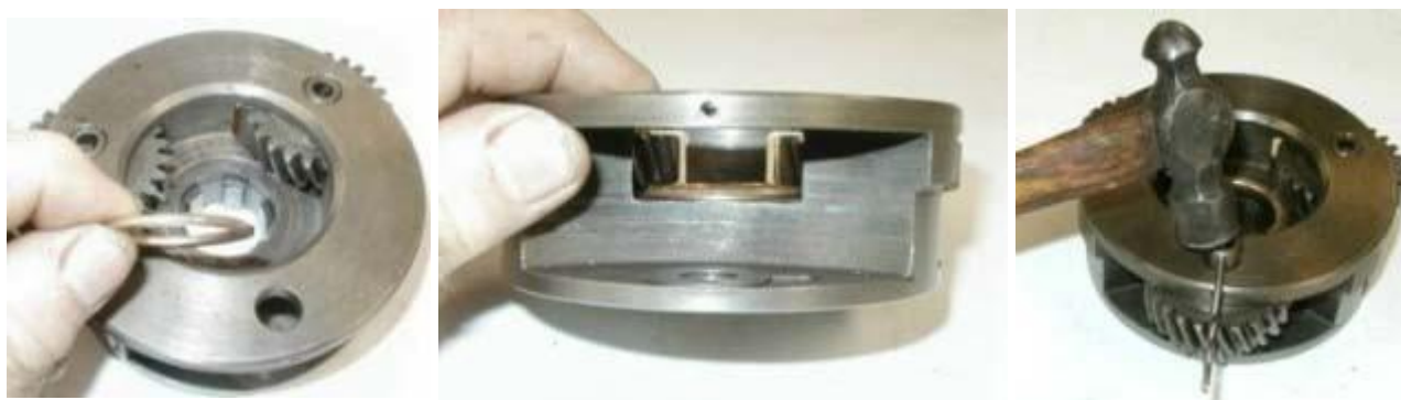
Fig. 11 installation des satellites
