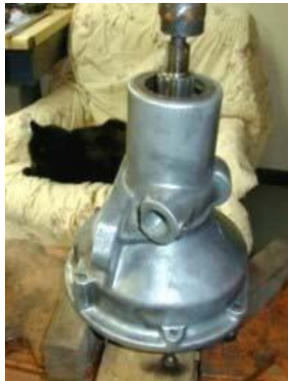
Fig. 27 Dépose de la couronne à la presse
