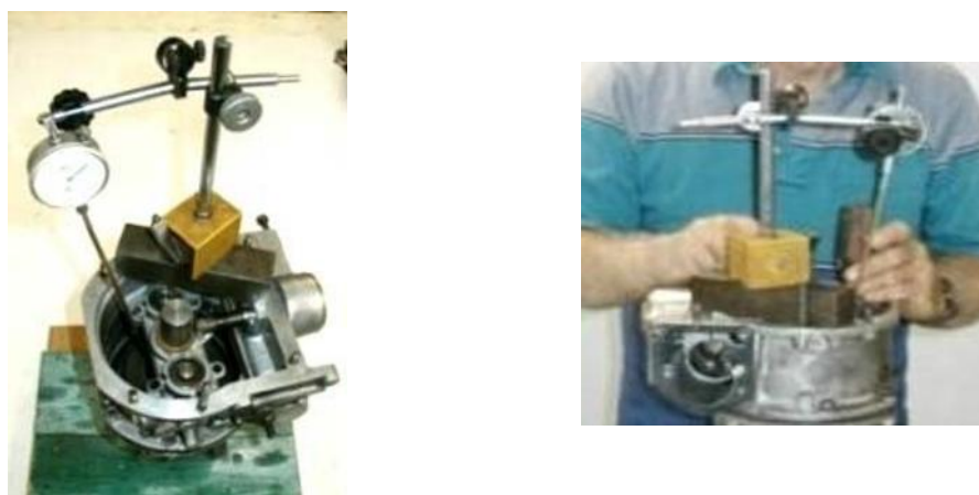
Fig. 14 Contrôle du jeu axial au comparateur
