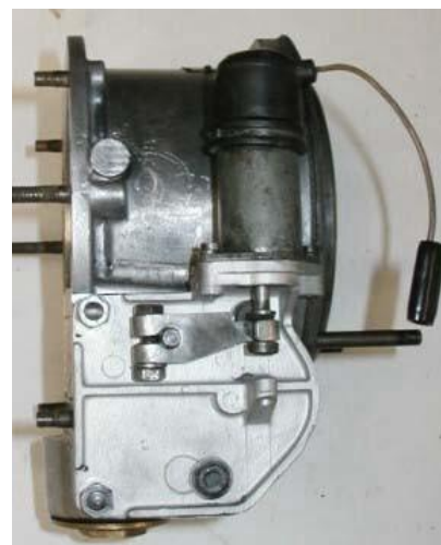
Fig. 27 Solénoïde en place
