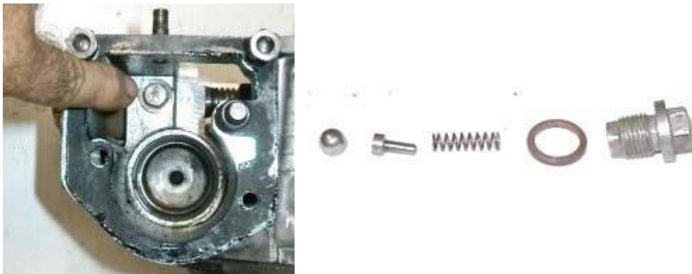
Fig. 16 Dépose du clapet anti-retour
