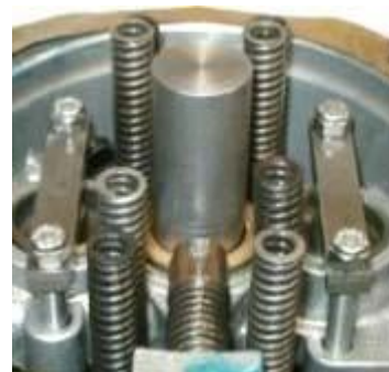
Fig. 21 mise en place des ressorts
