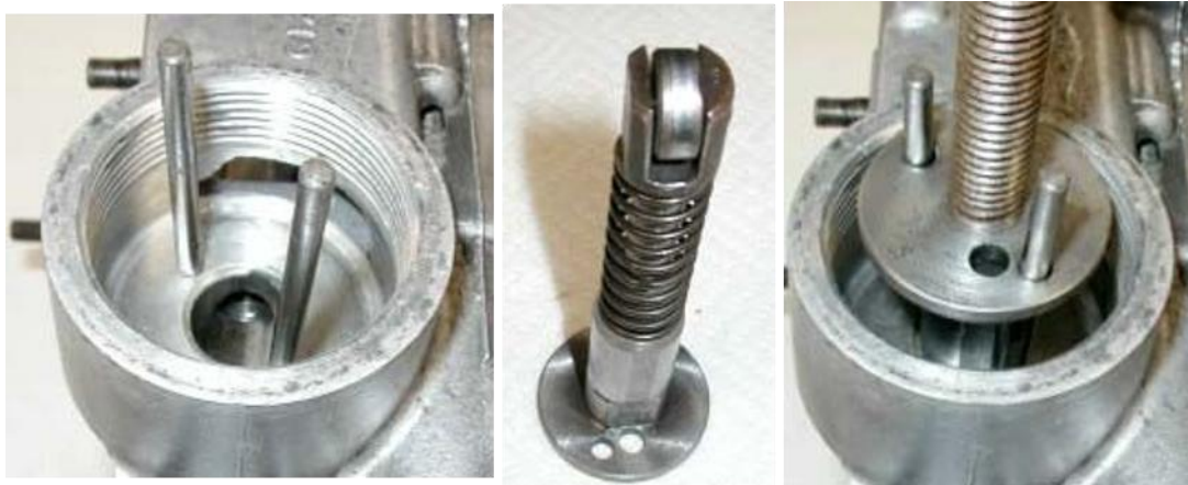
Fig. 18 Installation de la pompe
