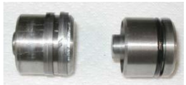
Fig.21 Comparaison des deux pistons A gauche l'ancien, à droite le nouveau
