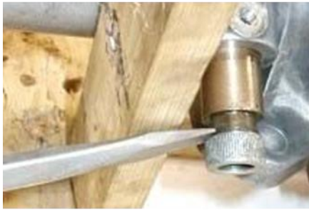
Fig. 6 Dépose de la commande du compteur
