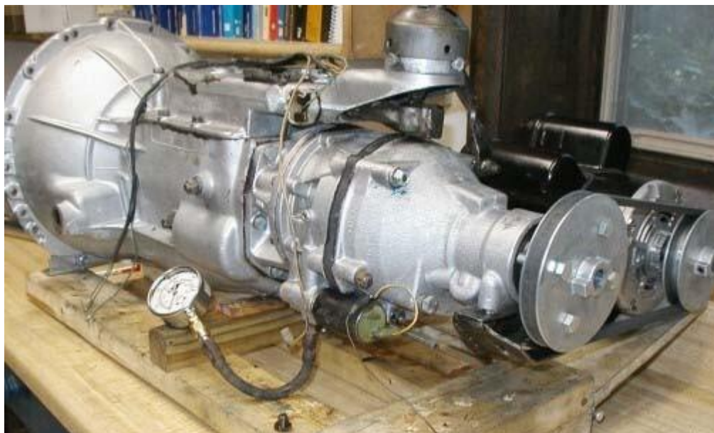
Fig. 15 Contrôle de fonctionnement de la soupape en réel
