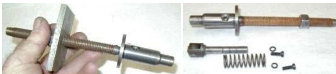
Fig. 18 Détail des pièces de la pompe avec son extracteur
