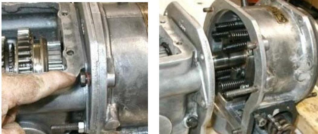
Fig. 10 Dépose du corp principal
