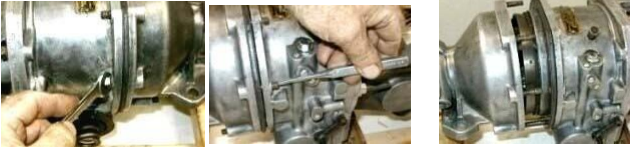
Fig. 8 Ouverture du capot en trois étapes
