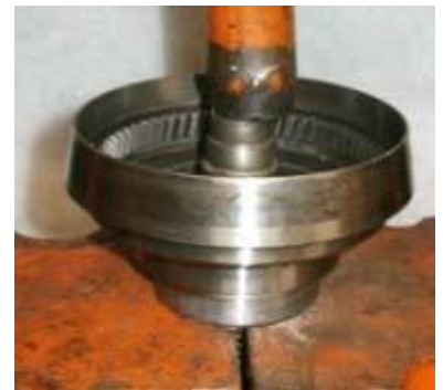
Fig. 1 Remontage du roulement avant à la presse
