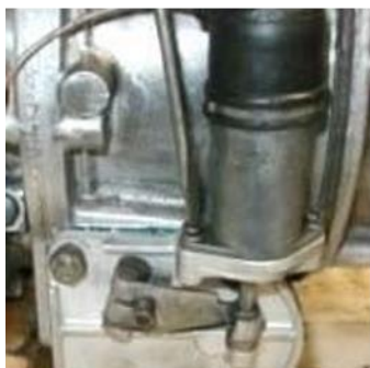
Fig. 1 Solénoïde en place
