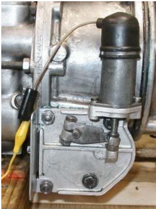
Fig. 12 Test solénoïde en place
