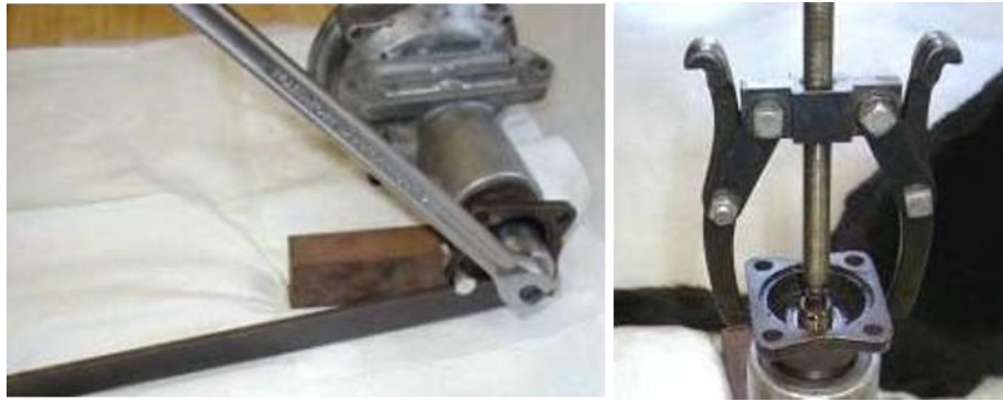
Fig. 25 Dépose de la bride arrière avec l'outil fait maison
