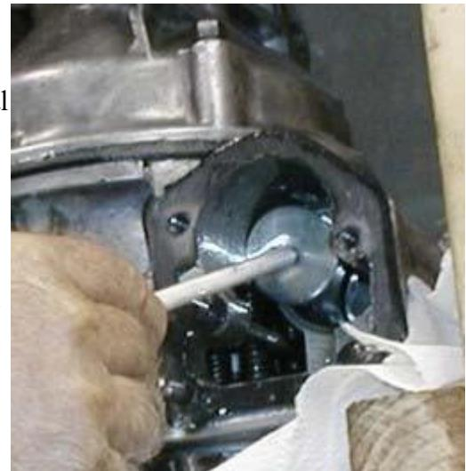
Avec trois rondelles, pression d'environ 390 Psi. Il se passe quelque chose avec plus de quatre rondelles - j'ai enfin compris, avec plus de quatre rondelles, le ressort doit être complètement comprimé avant le piston et ne peut se déplacer suffisamment pour exposer les trous de décharge de pression. Évidemment !
