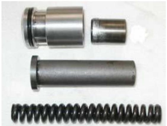
Il est possible de remplacer l'ancien accumulateur par le nouveau (le boîtier, le piston, le réglage de l'espacement et le ressort sont tous nécessaires). Le catalogue Victoria British recommande cette option si des ressorts, un piston ou des segments de rechange sont requis pour l'ancien accumulateur.
