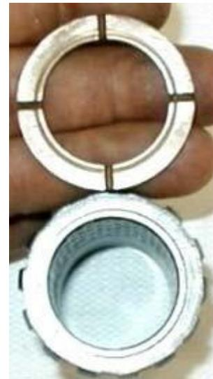
La surface rugueuse contre la rondelle de réglage devrait fonctionner correctement. Cette nouvelle rondelle a été retrouvée plus tard et installée lorsque d'autres problèmes sont survenus, nécessitant de nouveau le démontage comme discuté dans la partie IV.
