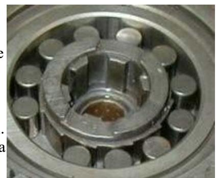
Imaginons maintenant ce qui se passerait si l'Overdrive était engagé en marche arrière : la couronne tenterait de tourner 22 % plus vite que l'arbre principal en rotation antihoraire. Cependant, comme indiqué précédemment, l'embrayage unidirectionnel empêche la couronne de
