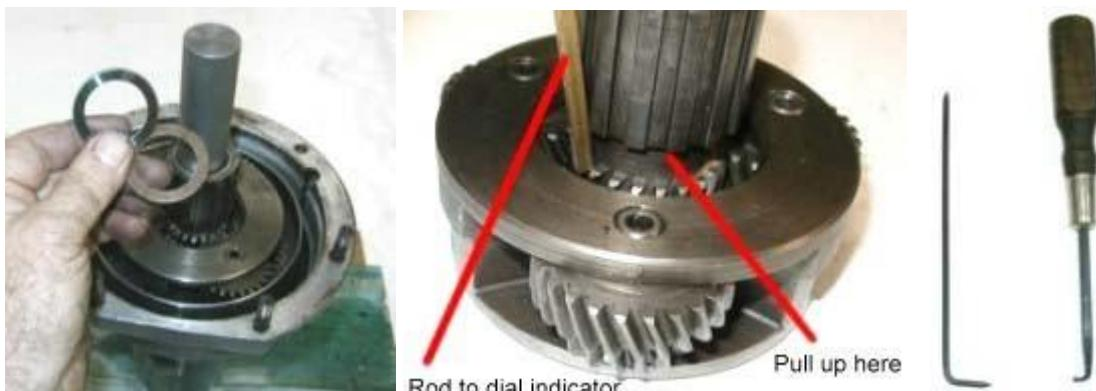
La photo de gauche ci-dessous montre la configuration réelle. Une barre d'acier assez grande était utilisée pour fixer la base magnétique du comparateur et assurer la stabilité.
