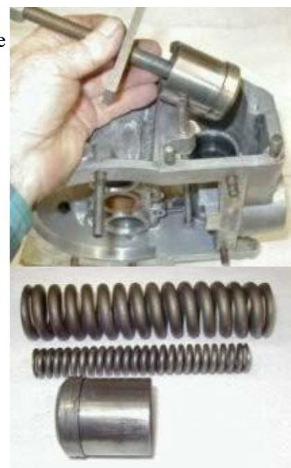
nominale nécessaire pour pousser le piston jusqu'aux orifices est de 360 Psi (24,8 bars).
