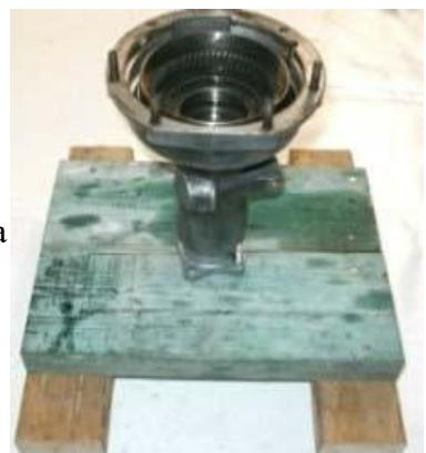
**Jeu axial de la couronne :** Le jeu axial de l'anneau a été mesuré avant le démontage de la pièce arrière. Ce jeu axial est ajusté en changeant la rondelle de réglage située entre le roulement arrière et un épaulement de l'arbre annulaire. Si le jeu axial est conforme aux spécifications avant le démontage, il le restera même après le remplacement des roulements, car ces derniers sont fabriqués avec une tolérance très serrée.
