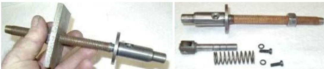
**Retrait des pistons de fonctionnement :** Les pistons de fonctionnement ont été retirés en les saisissant par leurs extrémités avec une pince et en les faisant tourner d'avant en arrière tout en tirant. Lors de l'inspection, un segment de piston s'est avéré cassé. Il est fort probable qu'il l'ait été dès l'installation. Ces segments n'étant plus disponibles, il a fallu acheter un piston de la nouvelle génération avec joint torique.
