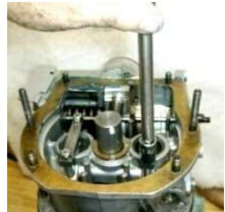
**Test préliminaire :** Avant d'installer l'overdrive sur la boîte de vitesses, un test à l'air comprimé est effectué pour vérifier le bon fonctionnement des soupapes et des pistons.
