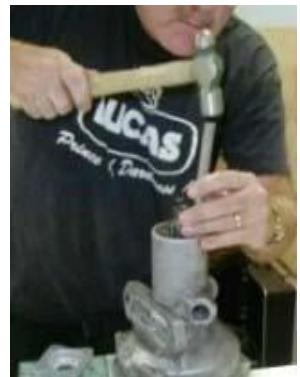
La bride arrière a été réinstallée. Cette fois, un peu de mastic d'étanchéité a été appliqué sous la rondelle pour éviter tout frottement. La bride a ensuite été tournée jusqu'à la fente suivante pour insérer la goupille fendue. Une fois le tout assemblé, l'arbre a été tourné à nouveau pour vérifier son bon fonctionnement.
