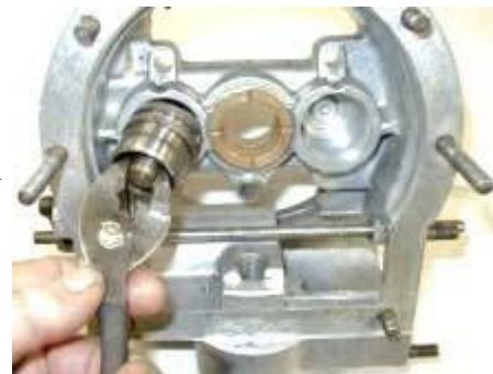
**Retrait de la soupape de commande :** La dernière pièce retirée du l'Overdrive principal est la soupape de commande. Le bouchon de la soupape se trouve en haut à droite du l'Overdrive. Malheureusement, les angles de l'hexagone ne permettent pas d'utiliser une autre clé. Un écrou de 1/2 pouce a été vissé sur le bouchon et soudé. L'écrou et le bouchon ont ensuite été retirés ensemble. Le bouchon avec le gros écrou est visible à droite.
