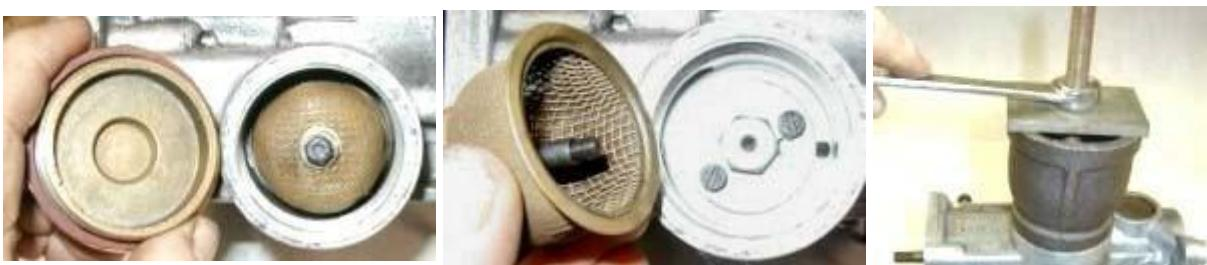
Le bouchon de vidange et le l'Overdrive de pompe extrait sont visibles à gauche, avec le piston et le ressort à droite. L'orifice latéral du l'Overdrive de pompe sert de siège à la bille du clapet anti-retour. Les composants de la pompe ont été examinés afin de détecter toute trace d'usure, et le siège du clapet a été inspecté pour vérifier l'absence d'entailles. La longueur libre du ressort a été mesurée et s'est avérée supérieure à la spécification minimale de 5 cm (2 pouces).
