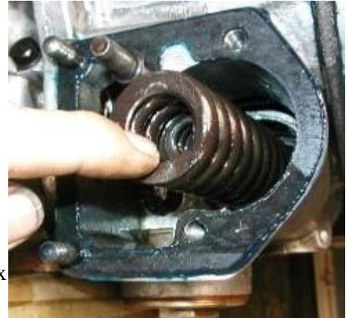
**Installation de la soupape anti-retour de la pompe :** La soupape anti-retour de la pompe est identique à la soupape de commande installée précédemment, sauf qu'il n'y a pas de longue tige. Les pièces sont lubrifiées, puis la bille, le piston et le ressort sont déposés dans le trou. Le bouchon avec la rondelle en cuivre est ensuite vissé et serré.
