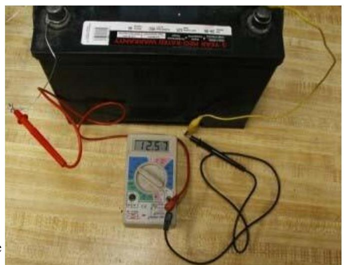
**Test de tension (12 volts) :** Pour tester la présence de 12 volts en un point d'un circuit, une extrémité est connectée à la sonde noire du multimètre et l'autre extrémité à la masse. Pour ces tests, le câble tressé de la
