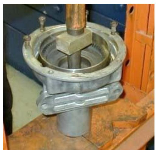
illustré à droite. Une attention particulière a été bagues à ce que le roulement de tête s'engage correctement dans son logement avant d'appliquer une force importante. De plus, la force appliquée n'a dépassé le minimum nécessaire à la mise en place du roulement afin de minimiser les contraintes sur ce dernier.
