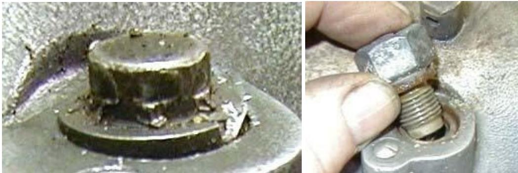
Les composants de la soupape de commande sont illustrés ci-dessous. Le bouchon et la rondelle en cuivre sont des pièces de rechange neuves.
