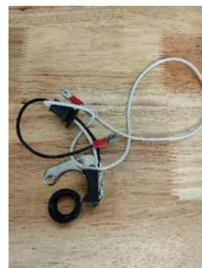
Fig. 11 Module d'allumage électronique de type PerTronix
