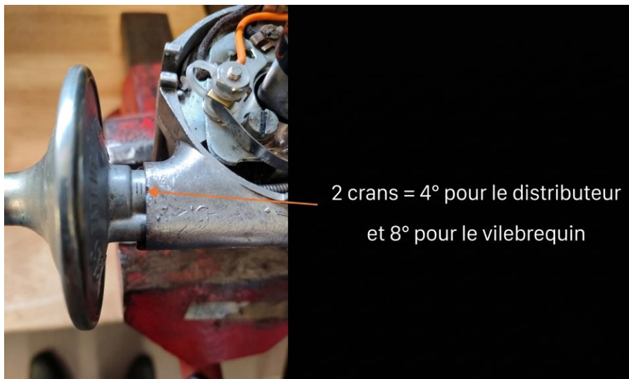
Fig. 9 Vernier d'avance à l'allumage
