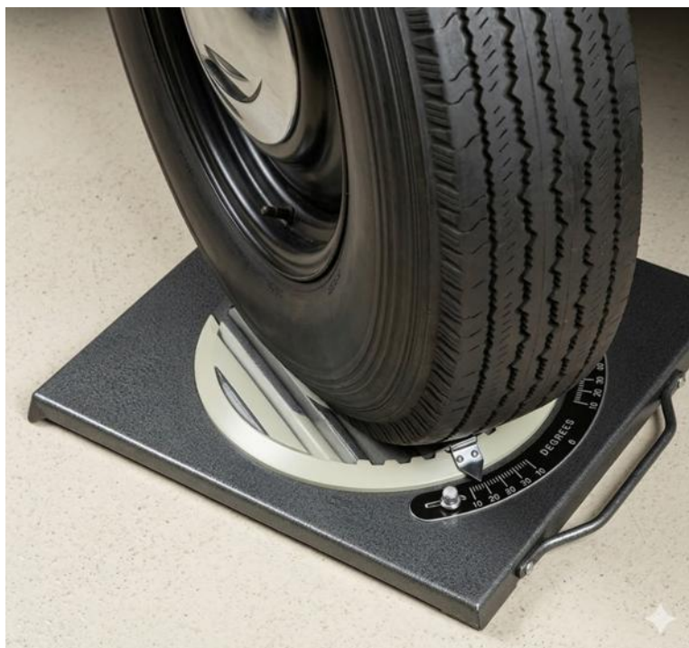
Fig. 4 Le manuel recommande l'utilisation du contrôleur de braquage Churchill, référence V.L. Churchill IZIU, ou d'un appareil équivalent.
