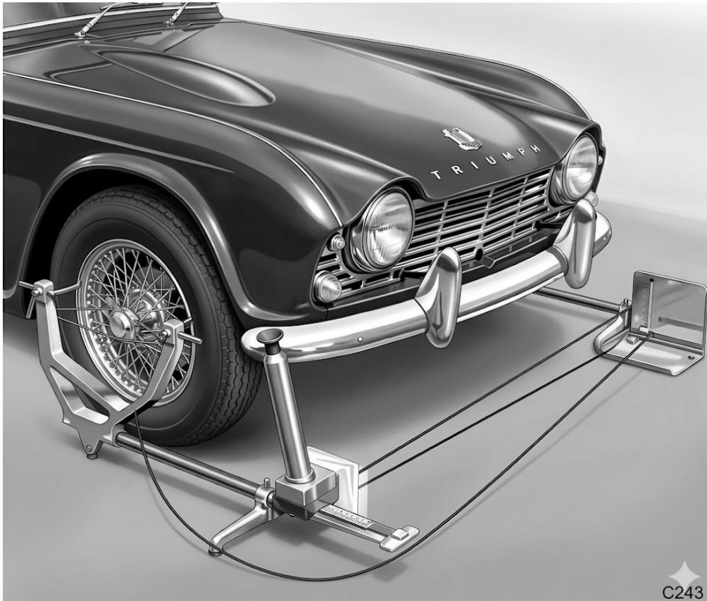
Fig. 43 Appareil de mesure en place
