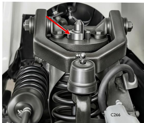
Fig. 22 Mise en place bague d'appui
