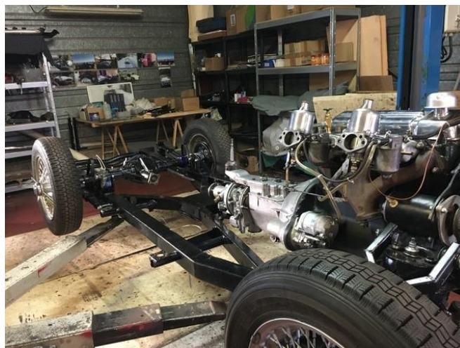
Fig 1 Le châssis restauré
