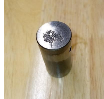
Fig. 8 Poussoir abîmé suite mauvais réglage
