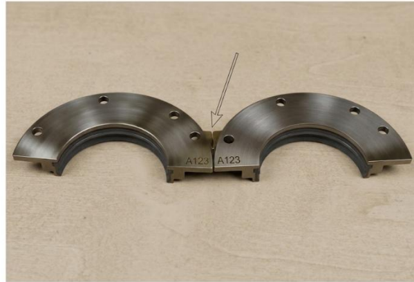
Joint d'étanchéité arrière du vilebrequin. Il s'agit d'une paire appariée et ils ne doivent pas être séparés.
