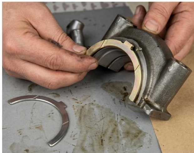
Installation de la rondelle de butée inférieure sur le chapeau de palier central.
