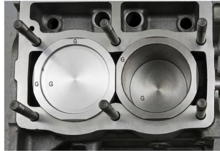
Les lettres d'identification estampées sur la calotte du piston et les chemises de cylindre. Notez également les plats sur la périphérie extérieure.
