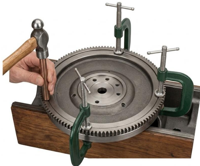
Illustration de l'utilisation de serre-joints à « G » pour la pose d'une couronne de démarreur de rechange.
