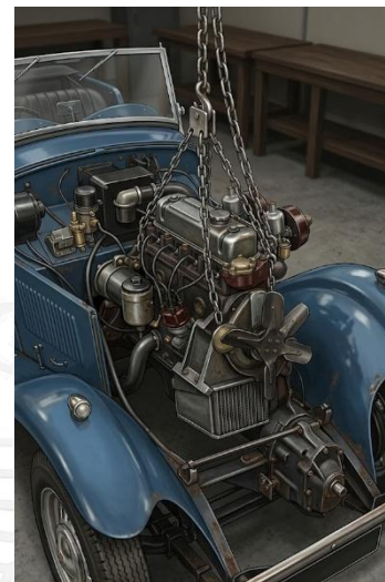
L'ensemble Moteur et Boîte de Vitesses en cours de dépose du châssis. Notez l'inclinaison « nez levé ».
