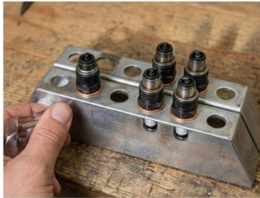
Bougies d'allumage prêtes à être montées sur le moteur. Notez les joints neufs et l'utilisation du support.
