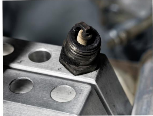
Encrassement par l'essence indiqué par un dépôt noir sec et duveteux sur l'isolant.
