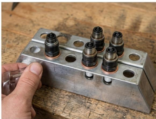
Fig. 46 Bougies d'allumage prêtes à être montées sur le moteur. Notez les joints neufs et l'utilisation du support.
