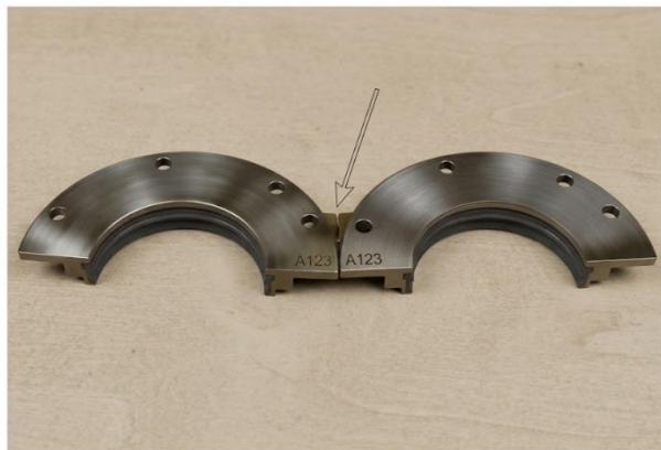
Fig. 32 Joint d'étanchéité arrière du vilebrequin. Il s'agit d'une paire appariée et ils ne doivent pas être séparés.
