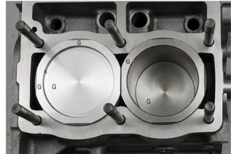
Fig. 20 Les lettres d'identification estampées sur la calotte du piston et les chemises de cylindre. Notez également les plats sur la périphérie extérieure.
