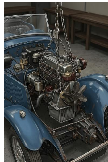
Fig. 31 L'ensemble Moteur et Boîte de Vitesses en cours de dépose du châssis. Notez l'inclinaison « nez levé ».
