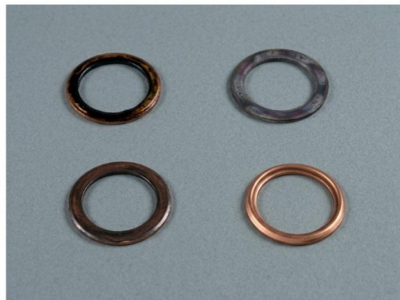
Fig. 41 Joints de bougies d'allumage dans divers états.
