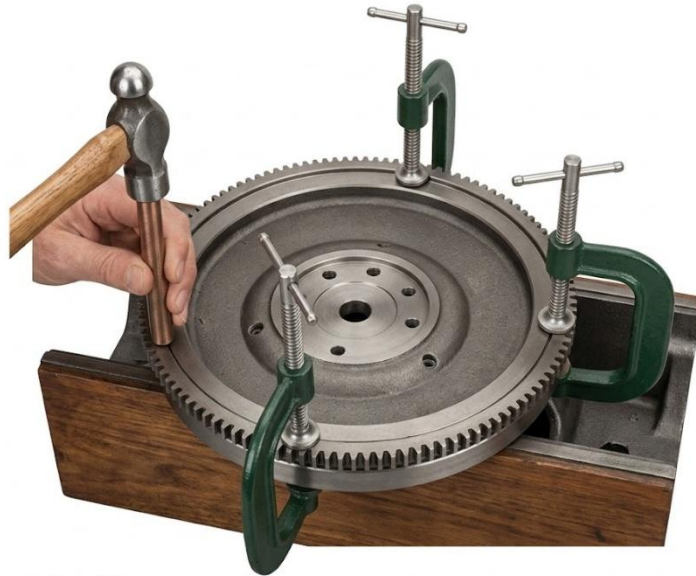
Fig. 10 Illustration de l'utilisation de serre-joints à « G » pour la pose d'une couronne de démarreur de rechange.
