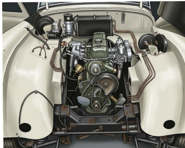
Fig. 30 L'avant de la voiture préparé pour la dépose du moteur et de la boîte de vitesses.
