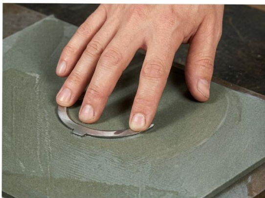
Fig. 18 Réduction de l'épaisseur d'une rondelle de butée. Cela ne doit être effectué que sur la face en acier.
