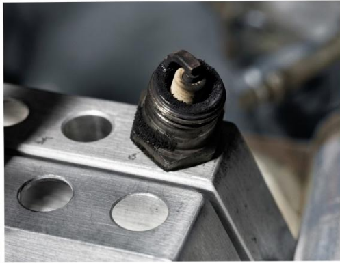
Fig. 40 Encrassement par l'essence indiqué par un dépôt noir sec et duveteux sur l'isolant.
