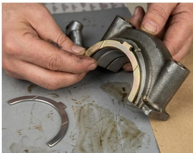
Fig. 34 Installation de la rondelle de butée inférieure sur le chapeau de palier central.
