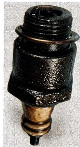
Fig. 39 Encrassement par l'huile indiqué par un dépôt noir, brillant et humide sur l'isolant.
