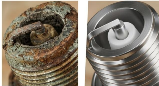
Fig. 48 Une photographie non retouchée d'une bougie d'allumage CHAMPION après 25 000 milles de service, comparée à une bougie neuve. La faible étincelle donnée par la première peut être facilement imaginée et justifie amplement notre recommandation selon laquelle, pour économiser de l'essence, les bougies devraient être changées avant qu'elles n'atteignent un tel stade d'usure, tel que celui montré sur la photographie.
