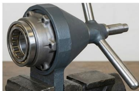
Fig. 8. Utilisation de l'outil n° 20S.93 pour monter les cages extérieures de roulement de moyeu.
