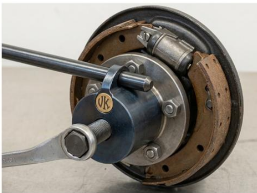
Fig. 9. Utilisation de l'outil n° M.86A pour déposer le moyeu arrière.
