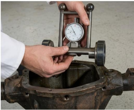
Fig. 20. Utilisation d'un bouton de masse spécial pour mettre la jauge à zéro
