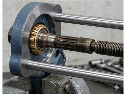
Fig. 17. Utilisation de l'outil n° TS.1 et de la presse n° S.4221A pour retirer le roulement de tête de pignon.
