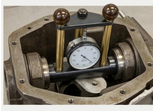
Fig. 20. Utilisation d'un bouton de masse spécial pour mettre la jauge à zéro
