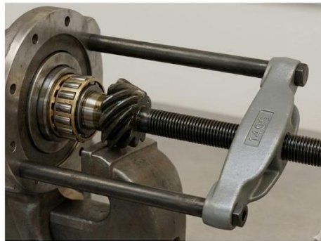
Fig. 24. Utilisation de l'outil No. S.103 et de la Presse S.4221A pour le montage du roulement de tête de pignon.
