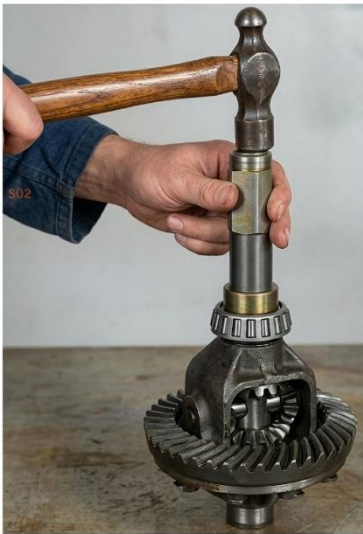
Fig. 32. Utilisation de l'adaptateur n° S.100 avec le manche n° 550 pour reposer les roulements de différentiel
