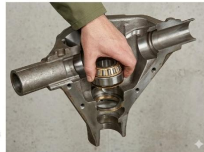
Fig. 23. Placement d'un jeu de cales d'épaisseur sous la bague extérieure du roulement de tête de pignon
