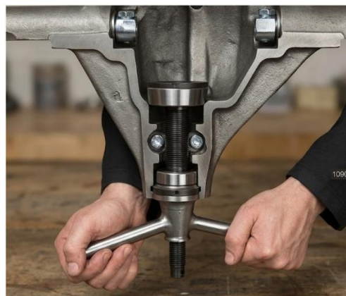
Fig. 18. Utilisation de l'outil n° M.70 pour installer les bagues extérieures roulements de tête et de queue de pignon
