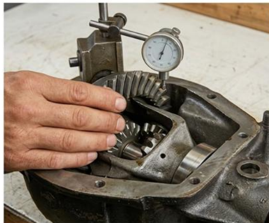
Fig. 33. Mesure du jeu d'engrènement de la couronne- planétaire
