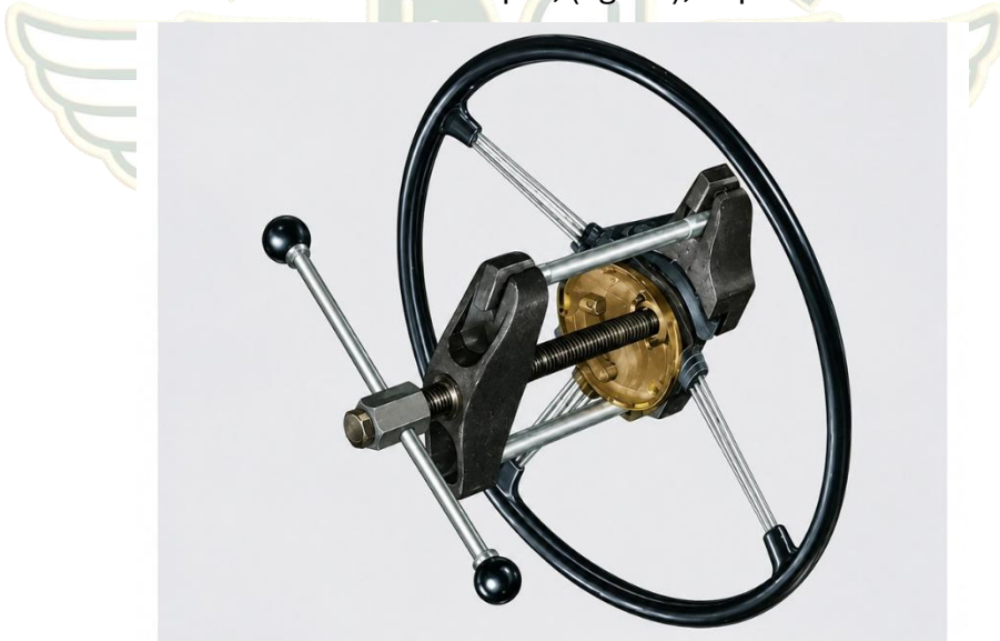
Fig. 12 Dépose du volant à l'aide d'un extracteur
