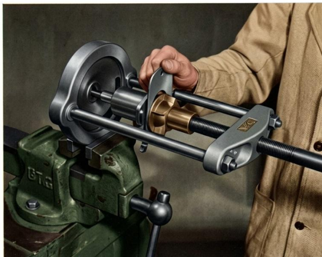
Fig. 9 Montage de la roue, en utilisant l'outil Churchill n° FTS 127.
