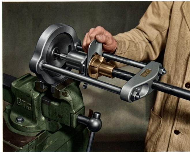
Fig. 9 Montage de la roue, en utilisant l'outil Churchill n° FTS 127.
