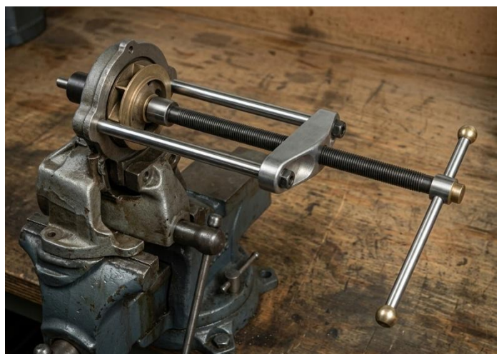
Fig. 8 Utilisation de l'outil Churchill n° FTS 127 pour déposer la turbine de la pompe à eau.
