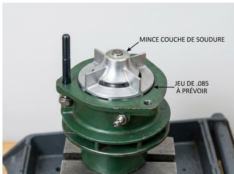
Fig. 10 Illustration du jeu correct entre la roue de la pompe à eau et le boîtier de roulement.
