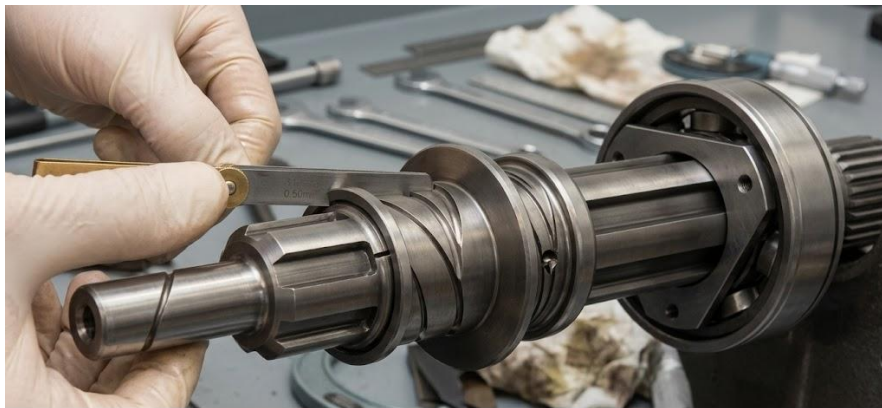
Fig. 30 Vérification du jeu d'extrémité global des bagues d'arbre principal avec jauge d'épaisseur.
