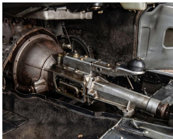
Fig. 4 Boîte de vitesses prête à être retirée.
