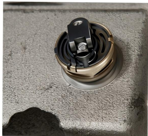
Fig. 36 Position de l'interrupteur d'isolement sur le couvercle de boîte de vitesses.
