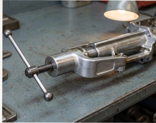
Fig. 6 Montrant le retrait de l'extension de boîte de vitesses avec l'outil Churchill n° 20S. 63.
