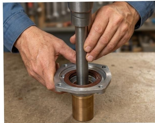
Fig. 28 Montage du joint d'étanchéité d'huile du carter avant avec l'outil no 20SM. 73.
