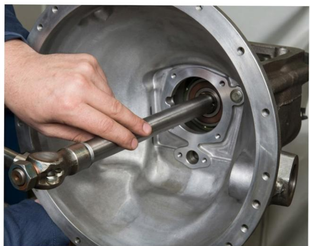
Fig. 11 Poussée de l'arbre principal vers l'arrière avec l'outil no 20SM1 pour libérer le palier central principal.
