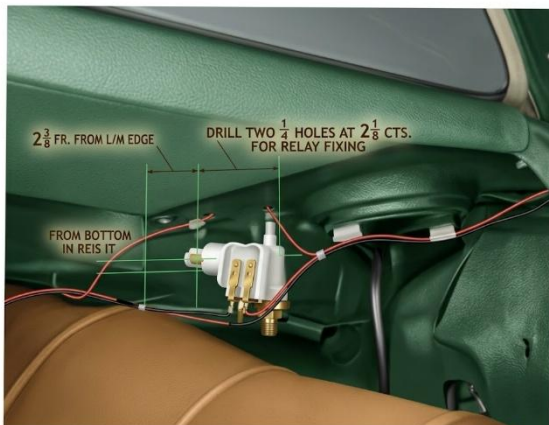
Fig. 38 Instructions pour le montage du commutateur de relais.
