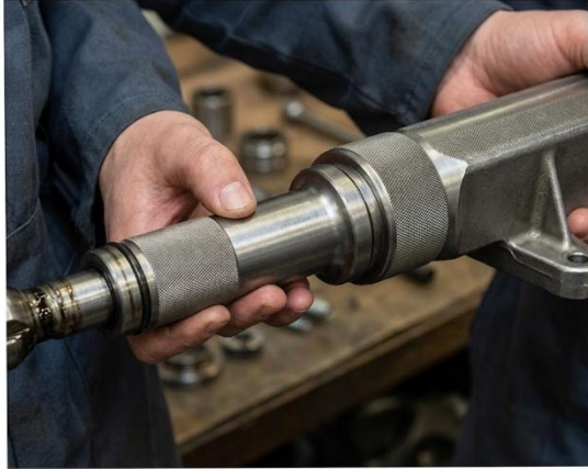
Fig. 26 Montage du joint d'étanchéité de carter d'extension avec l'outil Churchill n° 20S. 87.
