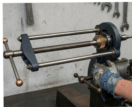
Fig. 22 Montage du roulement sur l'arbre de pignon constant avec la presse Churchill n° S4221 et l'adaptateur du jeu n° S4615.
