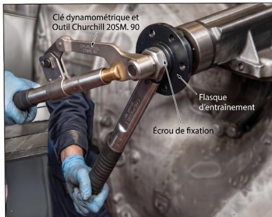
Fig. 27 Serrage de l'écrou de fixation du flasque d'entraînement avec clé dynamométrique et outil Churchill No. 20SM. 90.
