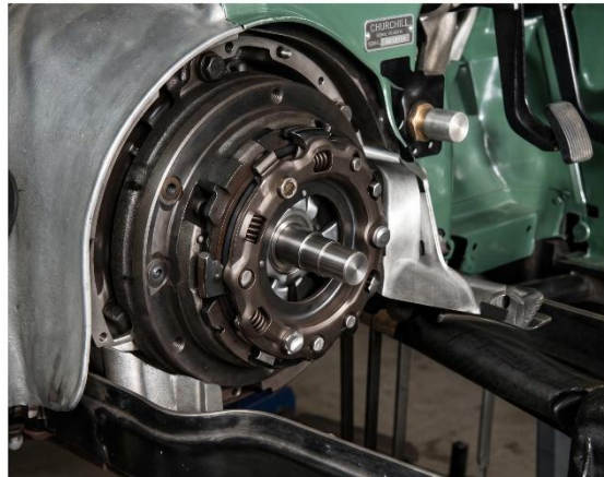
Fig. 5 Alignement du plateau d'embrayage avec le mandrin. Outil Churchill N° 20S. 72.
