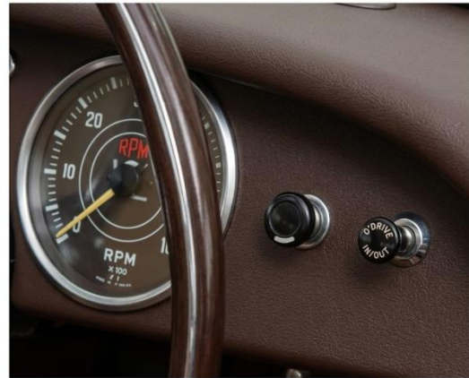
Fig. 37 Montre la position de la commande de surmultiplication.
