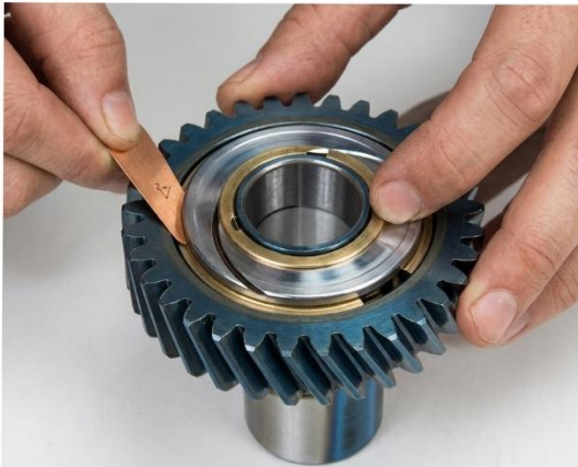
Fig. 17 Vérification du jeu axial du pignon fou de deuxième sur l'arbre principal.
