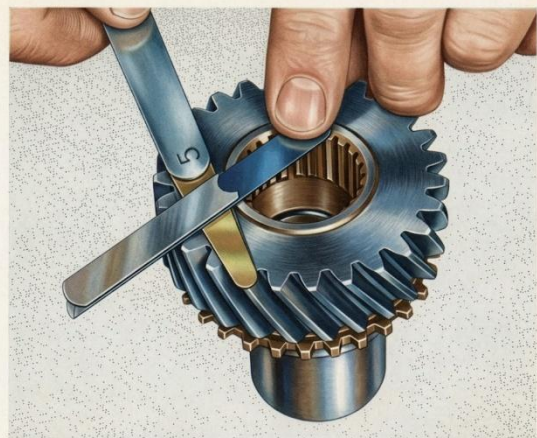
Fig. 18 Vérification du jeu axial du pignon fou de troisième de l'arbre principal.
